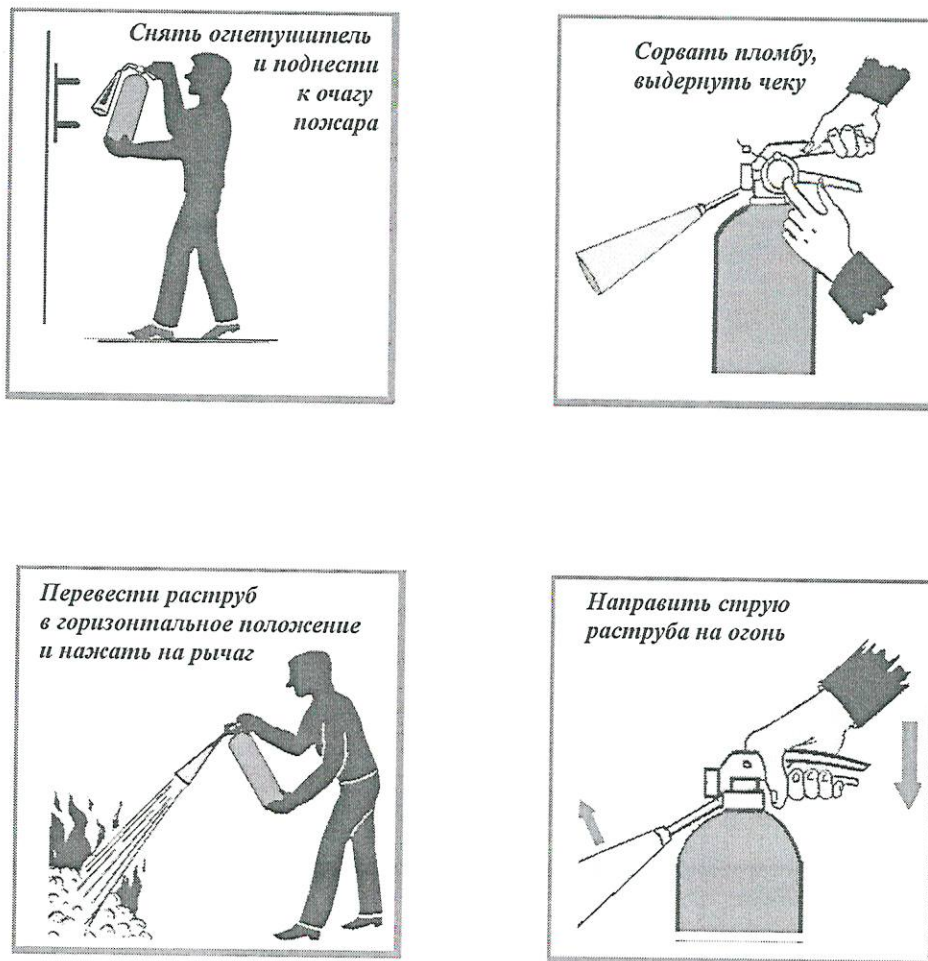
Рис. 8. Приведение в действие ручного углекислотного огнетушителя (плакат)
