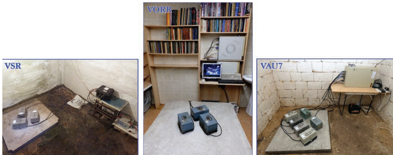
Пример размещения оборудования цифровых сейсмических станций в пунктах наблюдений (VSR – сельское поселение «Сторожевое»; VORR – сельское поселение «Воронеж»; VAU7 – сельское поселение «Архангельское»)
