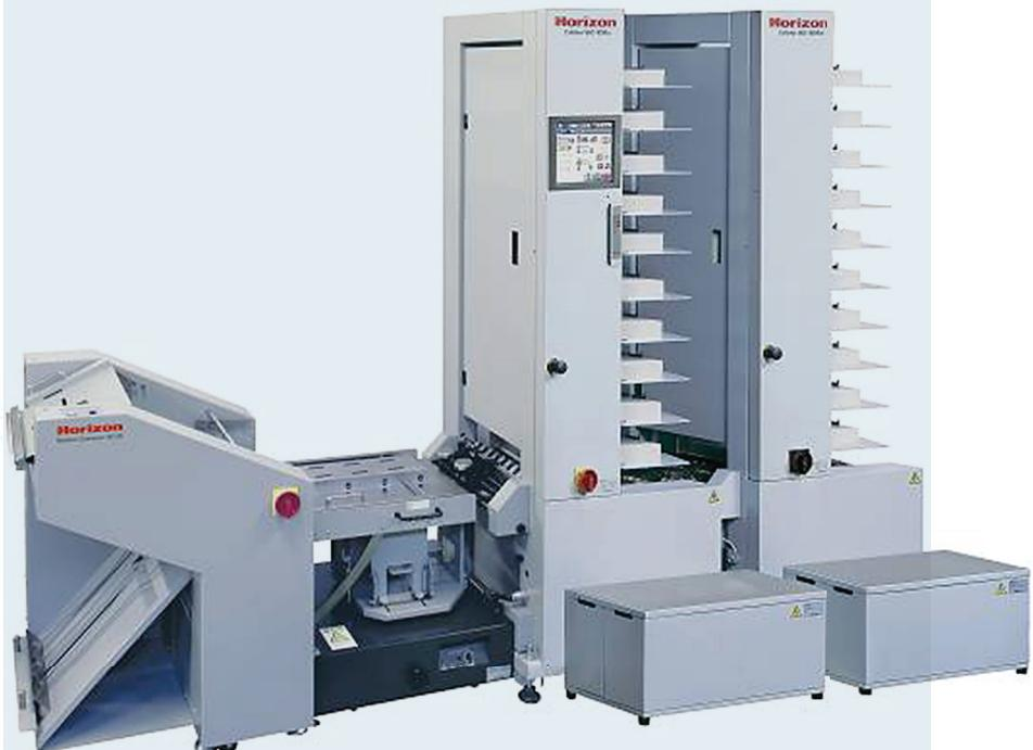
Листоподборочные башни Horizon VAC-1000A позволяют подбирать бумаги с самой разной фактурой, картон, ламинированные материалы в любом их сочетании. Машина оснащается вакуумными дисками оригинальной конструкции, предназначенными для подачи бумаг в самом широком диапазоне толщин, системой плавной регулировки силы всасывания дисков, регулируемыми разделителями.
