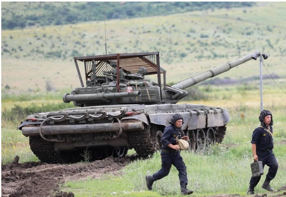
Рисунок 3. Пример устанавливаемой защиты от кумулятивных ракет.
