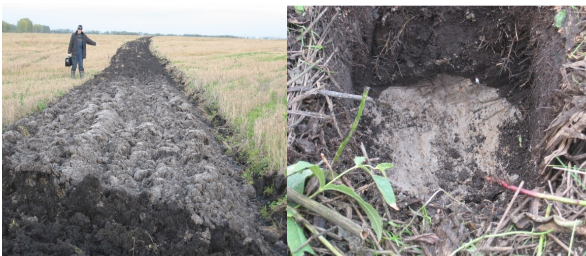
Рис. 3. Внешняя зона циркуммента - открытая зона выщелачивания имеет резкую внутреннюю границу (а). Погребенный горизонт выщелачивания в пределах днища (б)
