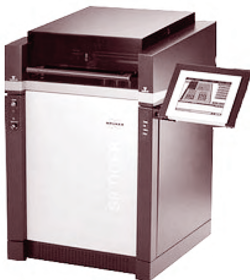
Волновой рентгенофлуоресцентный спектрометр Bruker S8 Tiger
